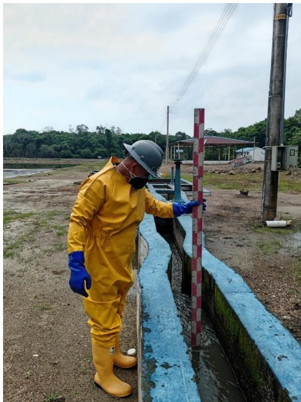
Toma de caudal en el sistema primario
