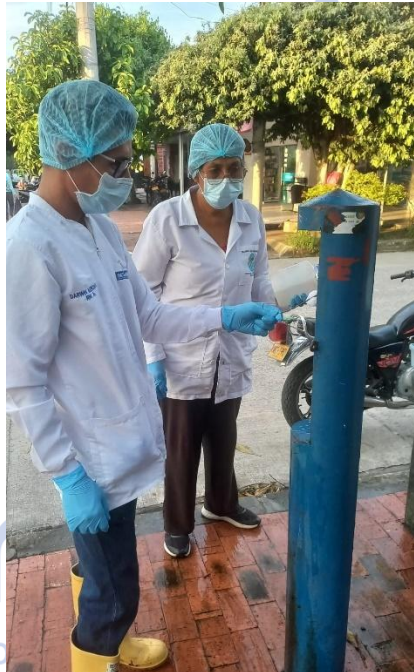
Toma de muestras en la red de distribución
